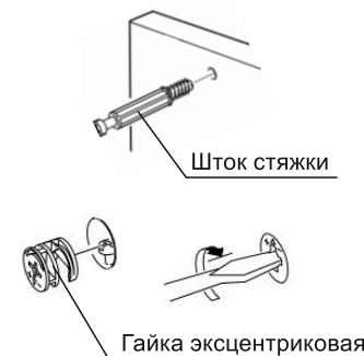
Схема 4. Установка стяжки эксцентриковой
